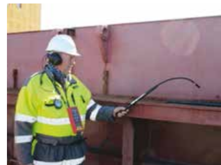
Pruebas de escapes por ULD
