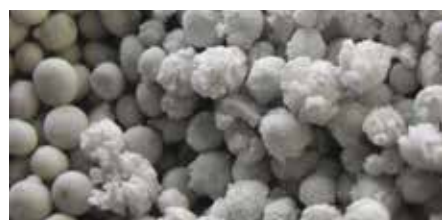
Fertilizante desintegrado debido a la absorción de agua.
