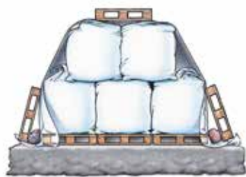
Almacenamiento exterior de empaques
