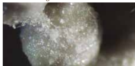
Los puentes de cristal entre las partículas del fertilizante causan compactación.
